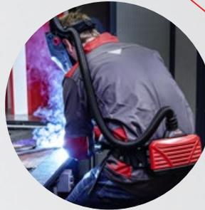
La fiable unidad de filtro del ventilador filtra hasta el 99,8 % de las partículas del aire ambiente perjudiciales para la salud del soldador.
